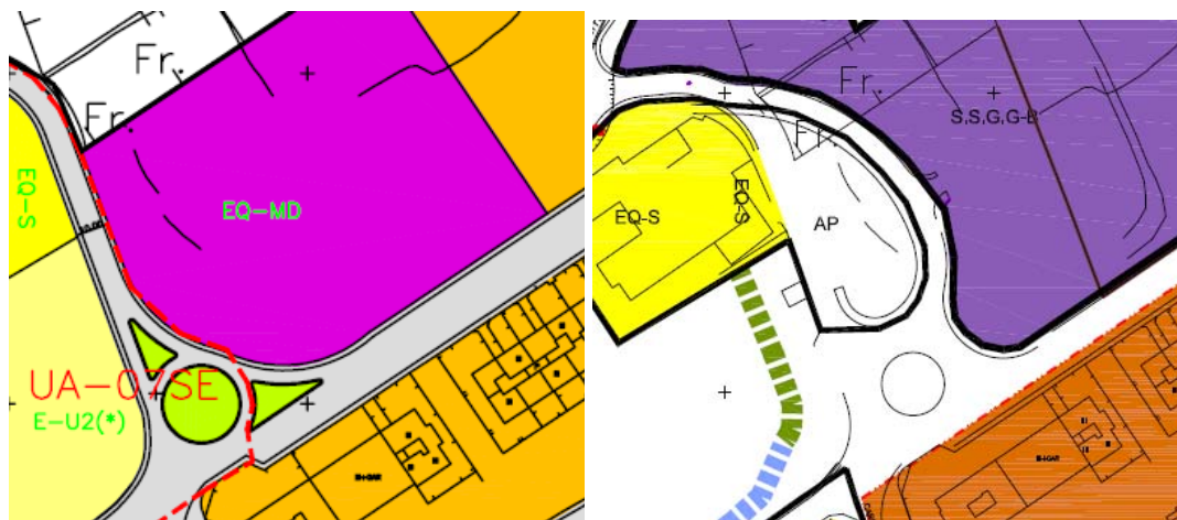
Figura 2. Propuesta de zonificación para la UA11-SE, antes (izquierda) y después de aplicar las conclusiones del Estudio Acústico para la zona. Se aleja el vial del centro asistencial (amarillo a la izquierda) y se suaviza la curva (mejora la seguridad).
